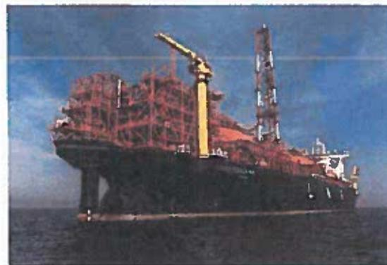
Il terminale FSRU Toscana ormeggiato al largo di Livorno, visto da prora; in primo piano la torretta di ancoraggio e il modulo di rigassificazione (per g.c. OLT).
